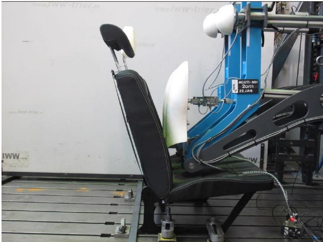
1.5) Kopfstütze und Rückenlehne entlastet / *headrest and backrest release*
