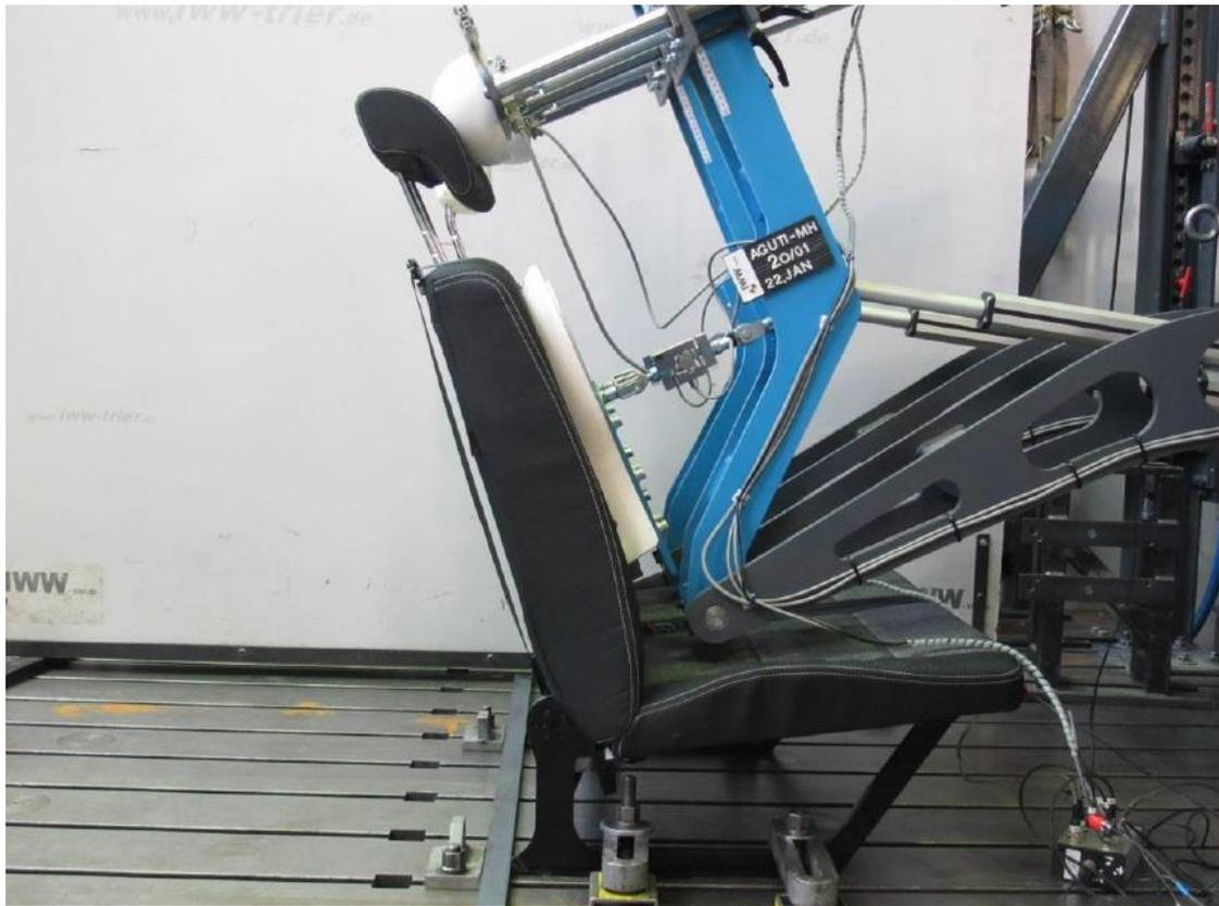
1.3) Kopfstütze mit Moment / head rest with Moment 373 Nm
