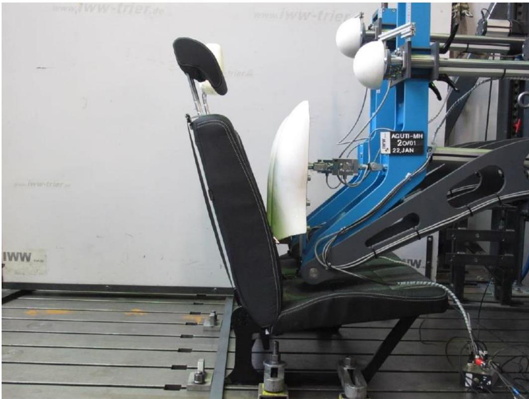
1.1) Versuchsaufbau vor der statischen Kopfstützenprüfung / test setup before static test of head rests
